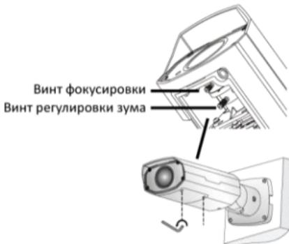
8. Включите камеру и отрегулируйте объектив с сервоприводом, чтобы получить четкое изображение. Для получения дополнительной информации о камере см. изделие.
