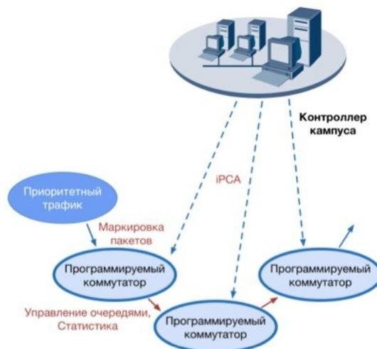
В отличие от вышеперечисленных методов, iPCA технология (Packet Conservation Algorithm for Internet – алгоритм сохранения пакетов в Интернет) может оперативно определять потоки видео и голосового трафика и моментально распознавать аварии в сетевых каналах, платах и даже микропроцессорах, существенно увеличивая эффективность O&M.
