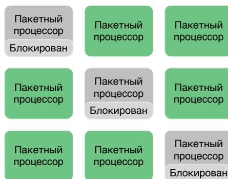
Изменение рабочей мощности транзисторов и частоты процессора позволяет снизить динамическое энергопотребление. Настройкой частоты в реальном времени руководит интеллектуальный спидометр, который обеспечивает регулировку в зависимости от объема передаваемых данных за счет изменения скорости поступления данных к группам NPU – это прямопропорционально влияет на показатели энергопотребления. ENP может аппаратно полностью отключать некоторые группы NPU, для снижения энергопотребления.
