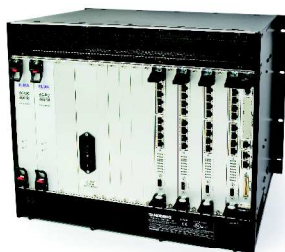
Вид сзади Медиа платы и платы сетевых интерфейсов
