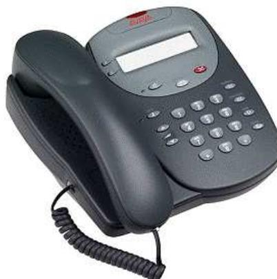
Терминал 5602SW поддерживает все вышеперечисленные функции плюс интегрированный коммутатор Ethernet для соединения с ПК.
