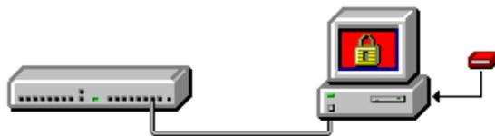
Лицензионный ключ подключается к параллельному порту ПК, порту USB или к последовательному порту системы Small Office Edition, блоков управления IP406 V2 и IP412 (необходимо, чтобы блок содержал 9-контактный последовательный порт). Лицензионный ключ содержит серийный номер, который используется для проверки наличия лицензии. Серийный номер лицензионного ключа должен предоставляться при заказе любых оплачиваемых приложений.
